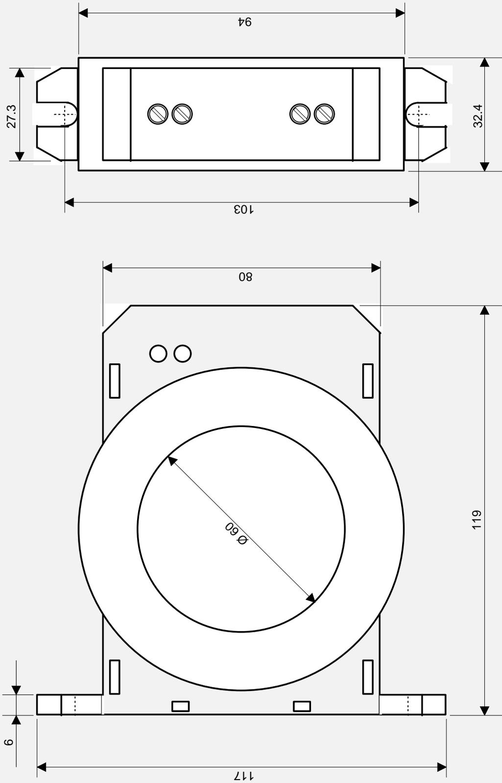
DIMENSIONES TRANSFORMADOR TOROIDAL: TRDF60
