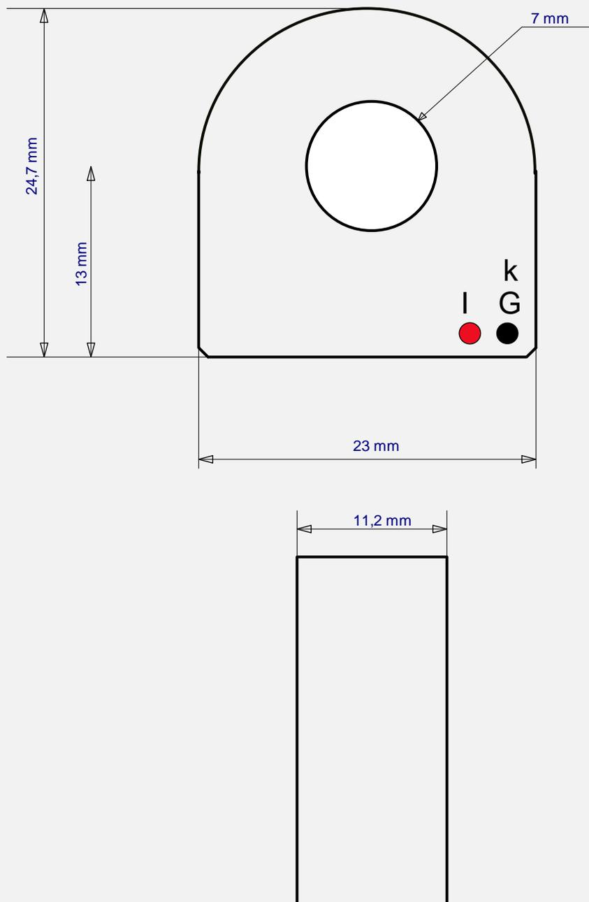
TRANSFORMADOR TOROIDAL TRDF25
